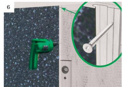
6 Verwenden Sie Schrauben à 35 x 3mm mit möglichst flachem Kopf und Dübel à 6mm
